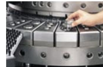
Voraussetzung für den automatischen Werkzeugwechsel: der Z-Revolver.
