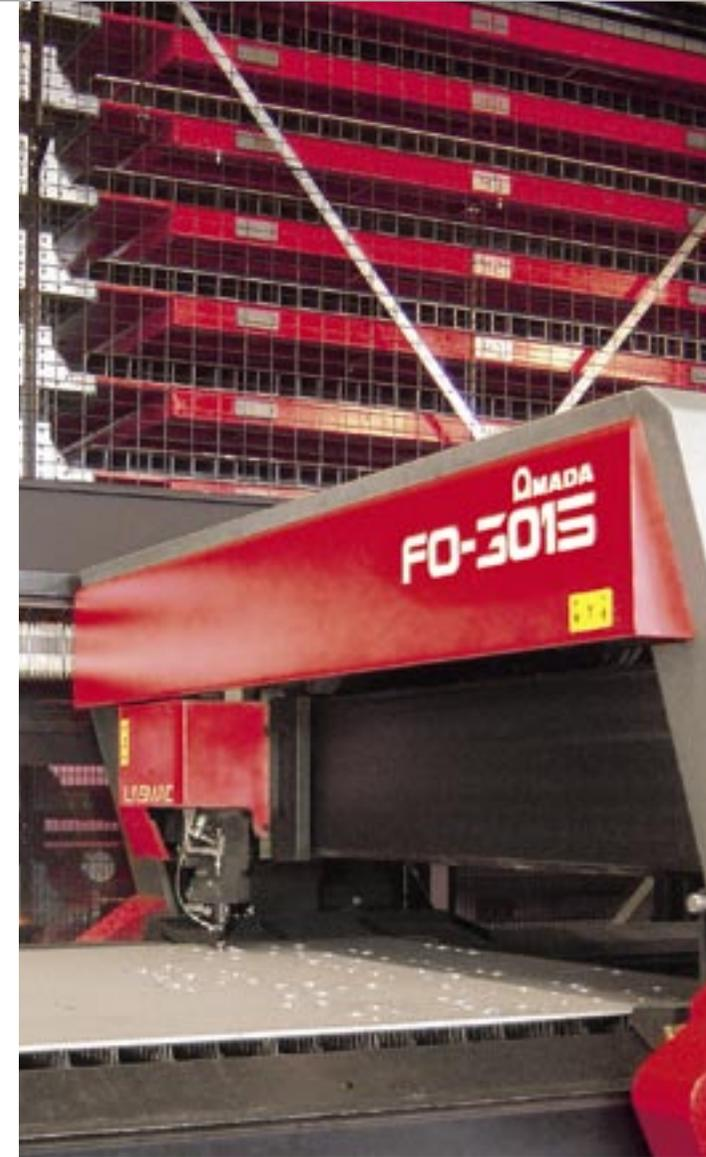
eine automatisierte Laserlinie, bei der teilgeschnittene Tafeln bei Bedarf automatisch wieder be- und entladen sowie Resttafeln zwischengelagert werden können. ■
