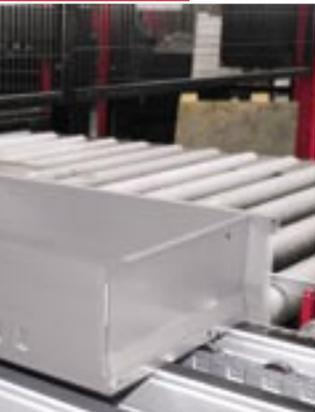
Werden in einem Durchgang abgekannt: Schubladen für den Werkstattwagen „Assistent“.
