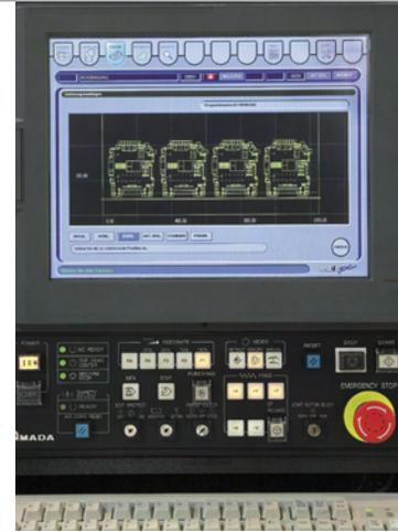
Die AMNC-Steuerung der AC-Stanzmaschinen erleichtert eine Mehrmaschinenbedienung.
