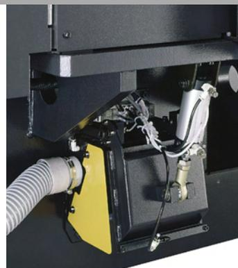
Ist bei der AC-Serie mit Bürstentisch Standard: die 300 x 300 mm große Teileklappe.
