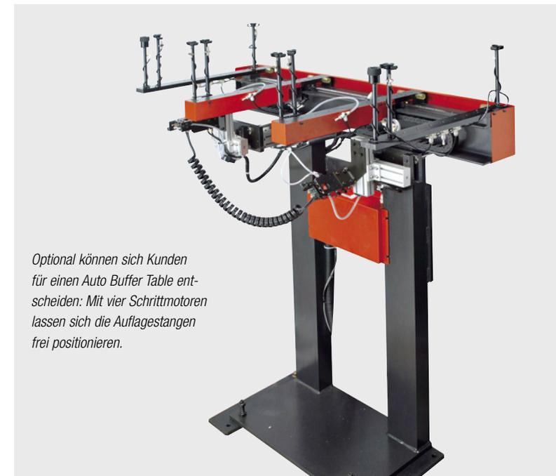
Optional können sich Kunden für einen Auto Buffer Table entscheiden: Mit vier Schrittmotoren lassen sich die Aufлагestangen frei positionieren.
