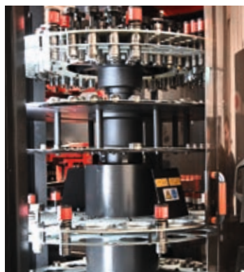
Die AMADA EML-2515AJe ist mit einem PDC-Werkzeugwechsler ausgestattet, der Stempel und Matrizen vollautomatisch austauscht.
