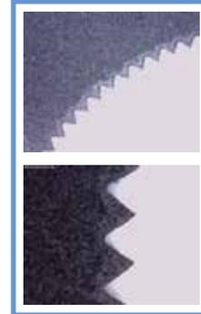
Der Faserlaser reduziert das Wegbrennen von Oberflächenbeschichtungen und Bauteilecken.
