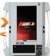
El control AMNC 3i utiliza programas offline para reducir el tiempo de montaje e incrementar la eficiencia de la máquina.
