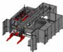
Kompakte Be- und Entladeeinheit mit Einzelteilsortierung (Laden/Entladen von Einzelpaletten)
