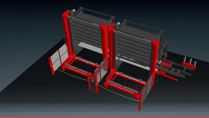
STOCCAGGIO E RIMOZIONE DEI PEZZI AUTOMATIZZATI PER PUNZONATRICI E MACCHINE COMBINATE
