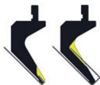
A causa dell'elevatissima resistenza del cuore, gli utensili AMADA si possono modificare in modo molto più sottile degli utensili convenzionali
