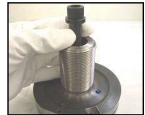
6. Mettre le porte-poinçon en place dans le guide en le tenant par la vis.
