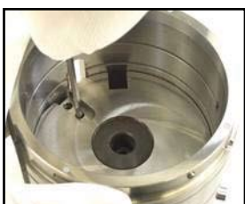
3. Sortir le porte-poinçon du guide en le dévissant complètement (Attention de ne pas abimer le filetage).
