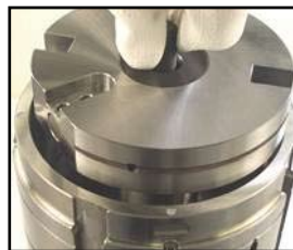
6. Mettre le porte-poinçon en place dans le guide en le tenant par la vis.
