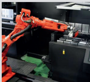
Stockage des poinçons et des matrices
