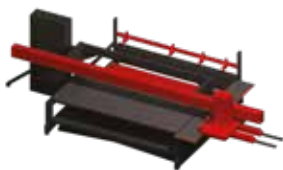
Solution de déchargement des pièces et des squelettes
