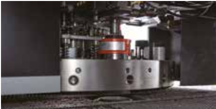
La table à brosse recouvre la tourelle inférieure
