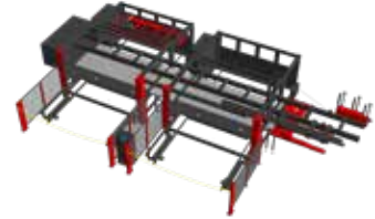
LA NTK + SR NTK Eine Materialpalette L/E + verbesserte Teileentnahme
