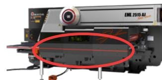
L'impostazione di una seconda origine assicura una facilità di posizionamento paragonabile a quella delle macchine combinate convenzionali.
