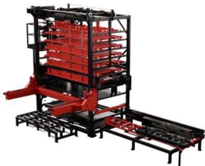
Le funzioni automatizzate di carico/scarico della lamiera per ENSIS-RI possono essere ottenute utilizzando il sistema STRI + AS LUL.
