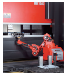
Aproximação para quinagem
