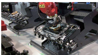
Pinza in fase di sostituzione automatica
