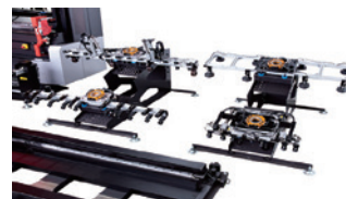
Sistema automatico di sostituzione della pinza (AGC)
