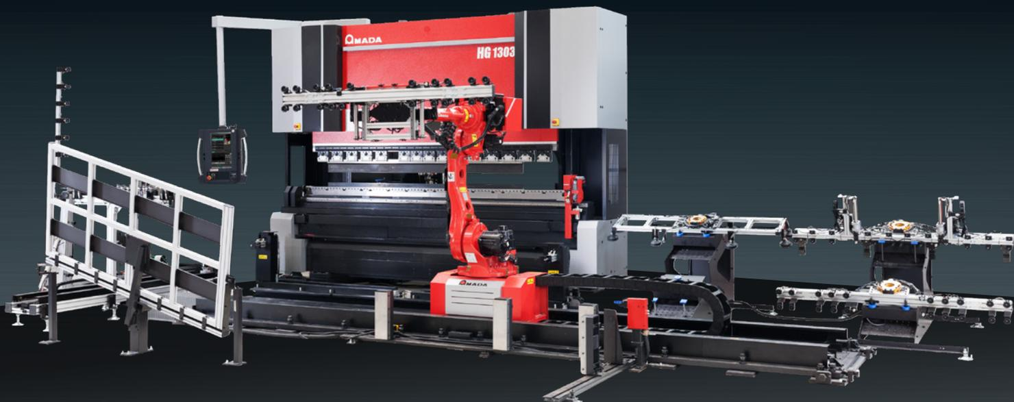
SISTEMA AUTOMATIZADO DE QUINAGEM PARA PEÇAS EM LARGA ESCALA
