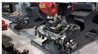
Gripper a ser trocado automaticamente
