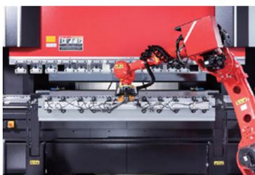
O sistema de *regripping* para peças compridas (frisos) consiste num braço automatizado e uma pinça para um tempo em vazio mínimo.
