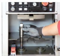
Mise en place de l’outil sur l’unité de mesure
