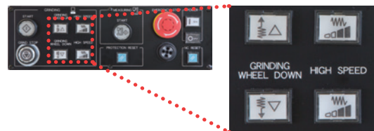
Appui sur le bouton de démarrage après avoir positionné la meule vers le bas
