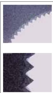
La découpe laser à fibre réduit l'effet de fusion sur les surfaces revêtues et les bords découpés.
