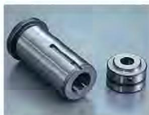
Se nella torretta non è disponibile una stazione di una specifica dimensione, si può installare una riduzione che adatta il punzone di una famiglia più piccola in una stazione della famiglia più grande. La riduzione in foto serve per installare un utensile A(1/2") in una stazione B(1/4")
