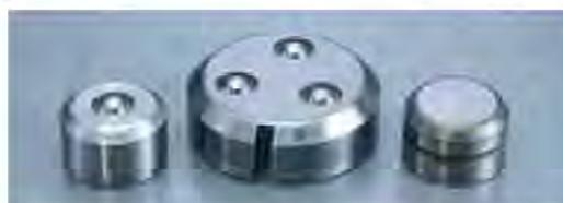
Le matrici a rullo e quelle piene si possono montare sulle stazioni della torretta inferiore. Si possono montare su stazioni inutilizzate per prevenire la deformazione di lamiere troppo sottili, per proteggere dai graffi la superficie inferiore del foglio, o per evitare le collisioni durante la lavorazione verso il basso.
