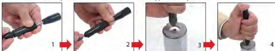
1. Montare la testina intercambiabile adatta per l'espulsore sfridi
