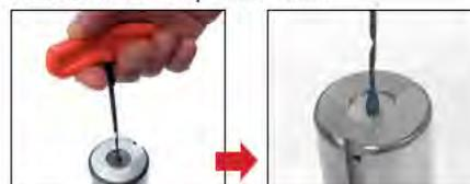
1. Avvitare l'attrezzo di rimozione sull'espulsore
