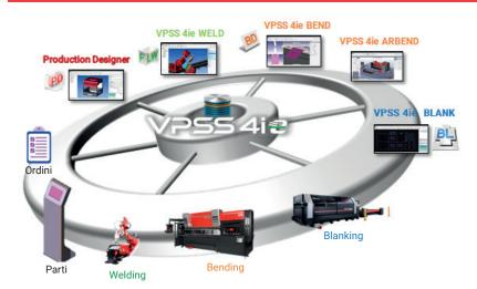
Con il VPSS 4ie, è possibile trasmettere e ricevere i dati del programma di lavorazione attraverso una rete mentre la macchina lavora.
