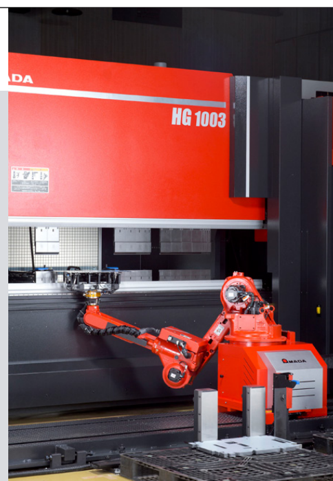
La piegatrice robotizzata HG-ARs di Amada offre una soluzione completa e avanzata per la lavorazione di lotti diversificati
