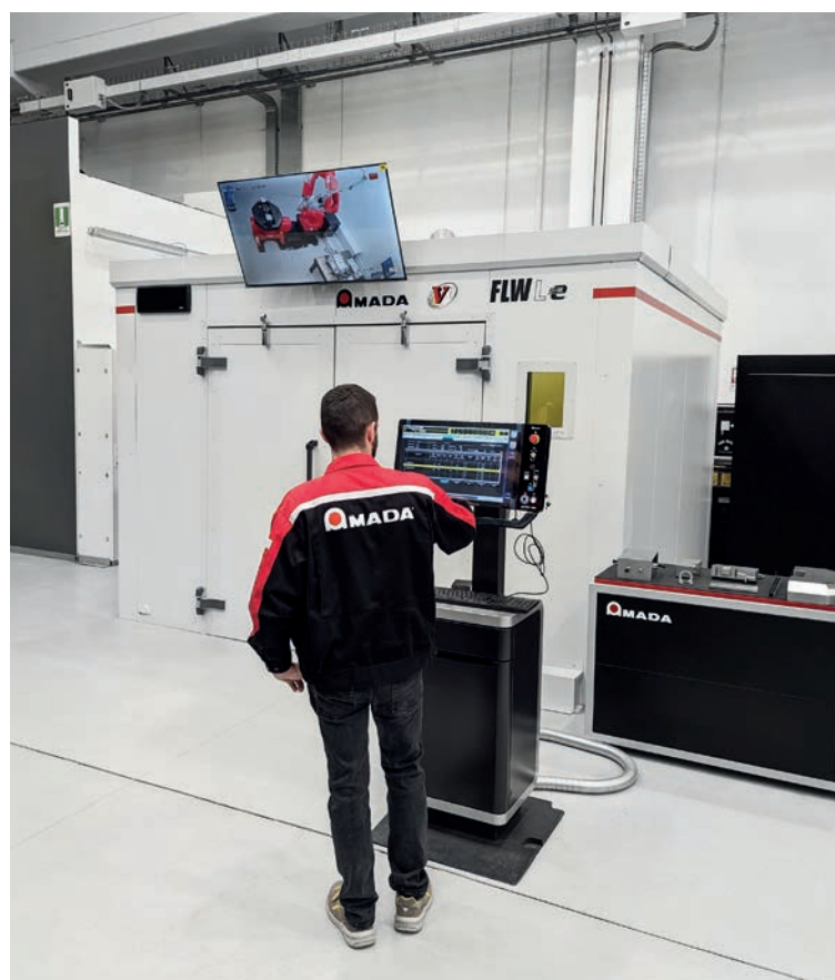
La cella FLW-3000 Le ha dimensioni molto compatte con un'impronta a terra di 3.600 x 3.600 mm.
