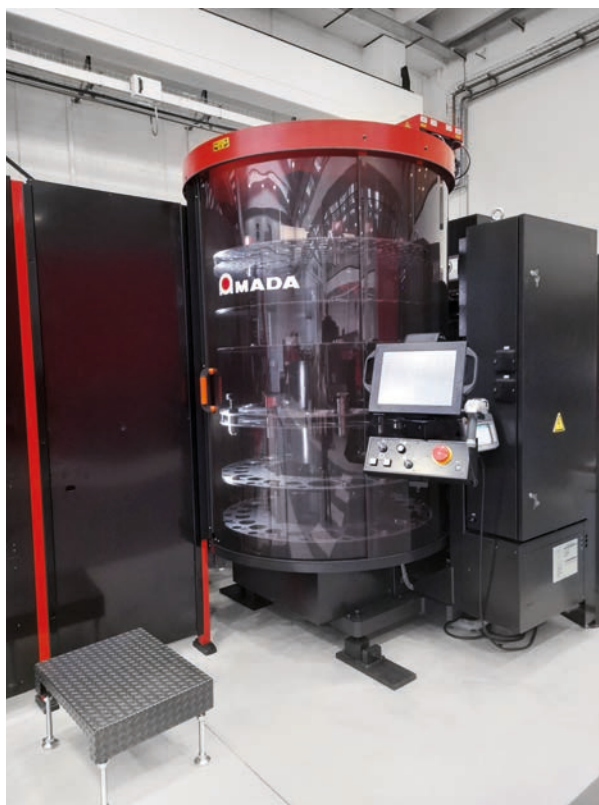
Il Punch Die Changer permette di stoccare un massimo di 220 punzoni e 440 matrici
