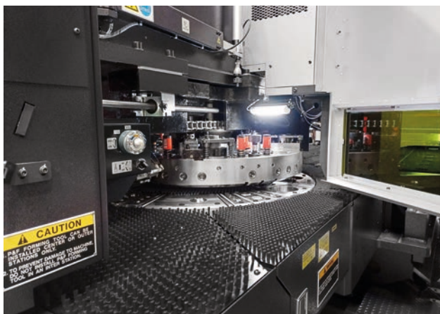
Dettaglio interno della torretta Z con stazioni rotanti indexate
