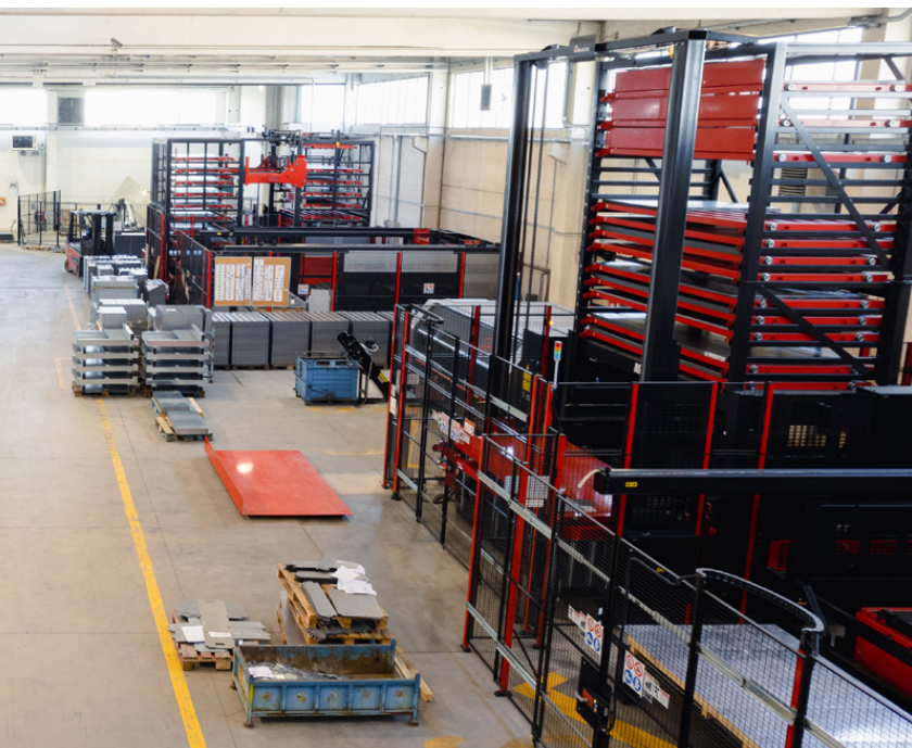
Vista reparto di taglio di Elea, dove sono installati i due impianti di taglio laser Amada, completi di sistemi automatici a torre di carico/scarico, sistemi di prelievo, smistamento e impilaggio automatico di parti tagliate a laser
