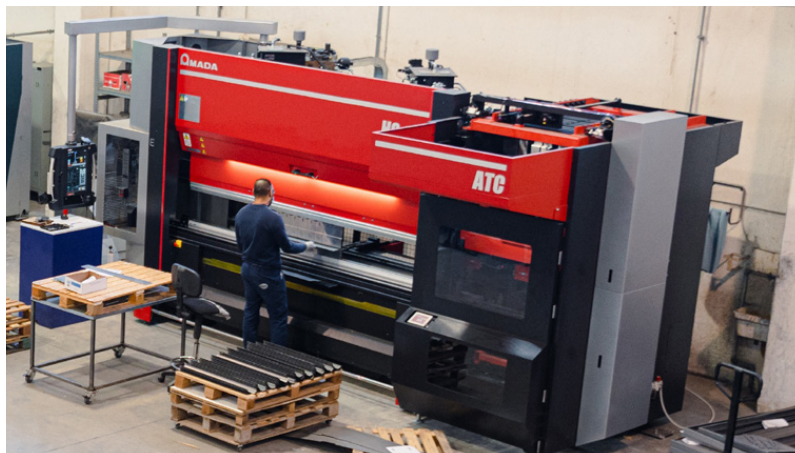
Nel reparto piegatura di Elea sono presenti anche quattro presse piegatrici Amada, tra cui due HG-1003ATC con cambio utensili automatico
