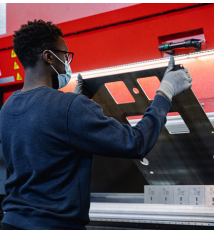
Nel reparto piegatura di Elea sono presenti anche quattro presse piegatrici Amada, tra cui due HG-1003ATC con cambio utensili automatico
