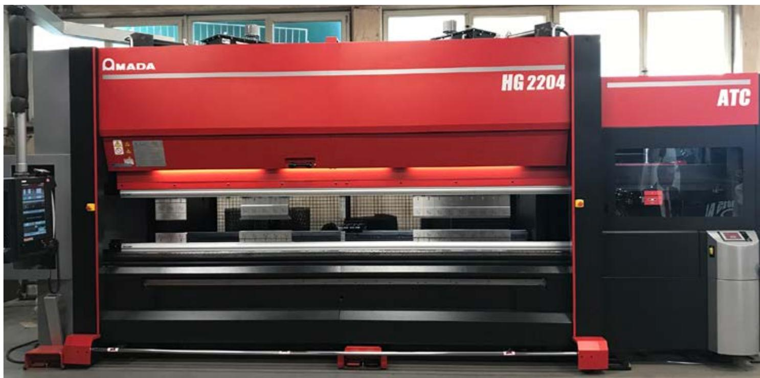
La piegatrice HG 2204 ATC di AMADA, grazie al cambio utensili automatico, può attrezzare in massimo 2 minuti anche il setup più complesso
