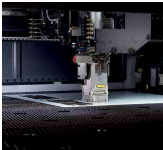
A sinistra LC-C1 AJ è una combinata con unità di punzonatura elettrica da 20 tonnellate e laser da 3 kW
