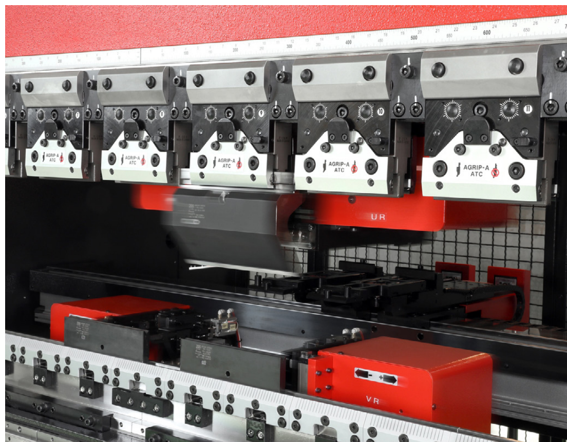
AMADA HRB-ATC durante l'attrezzaggio automatico
