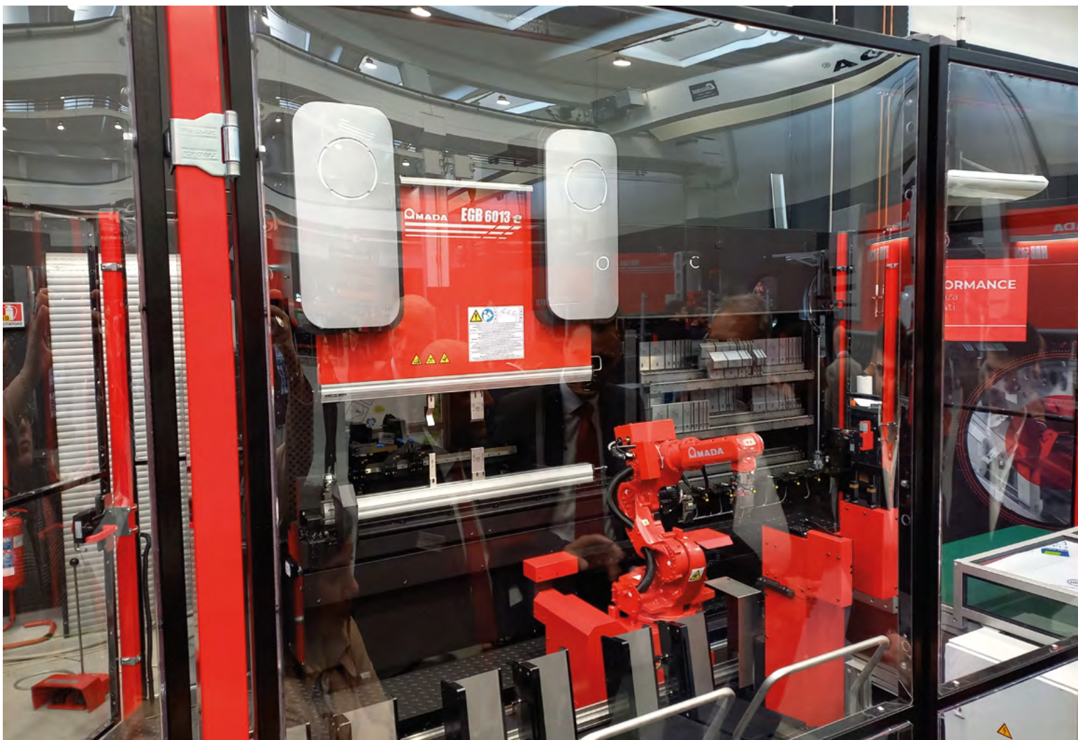
Nella cella EGB-6013ARce, la tavola si muove a 250 mm/s, e mantiene questa velocità costante sia in fase di discesa che di risalita, raddoppiando l'efficacia operativa rispetto ai sistemi tradizionali.
