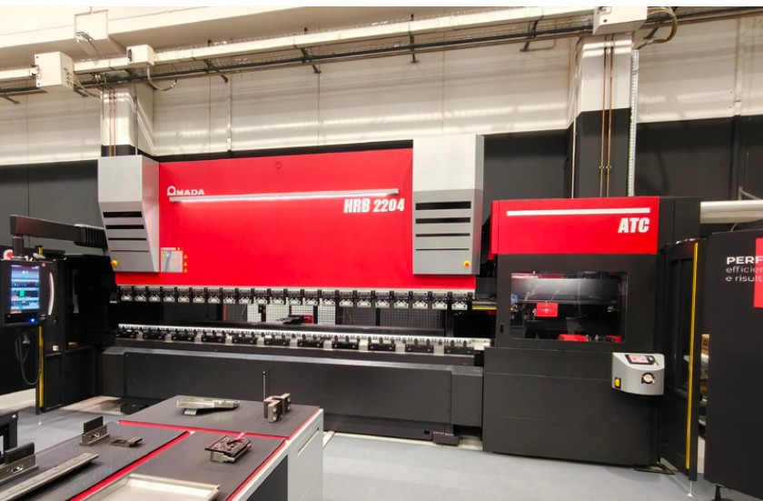
Pressa piegatrice idraulica HRB da 220 tonnellate con sistema di cambio utensili automatico ATC. Una soluzione affidabile particolarmente adatta al mondo della subfornitura per via della rapidità dei cambi di setup utensili
