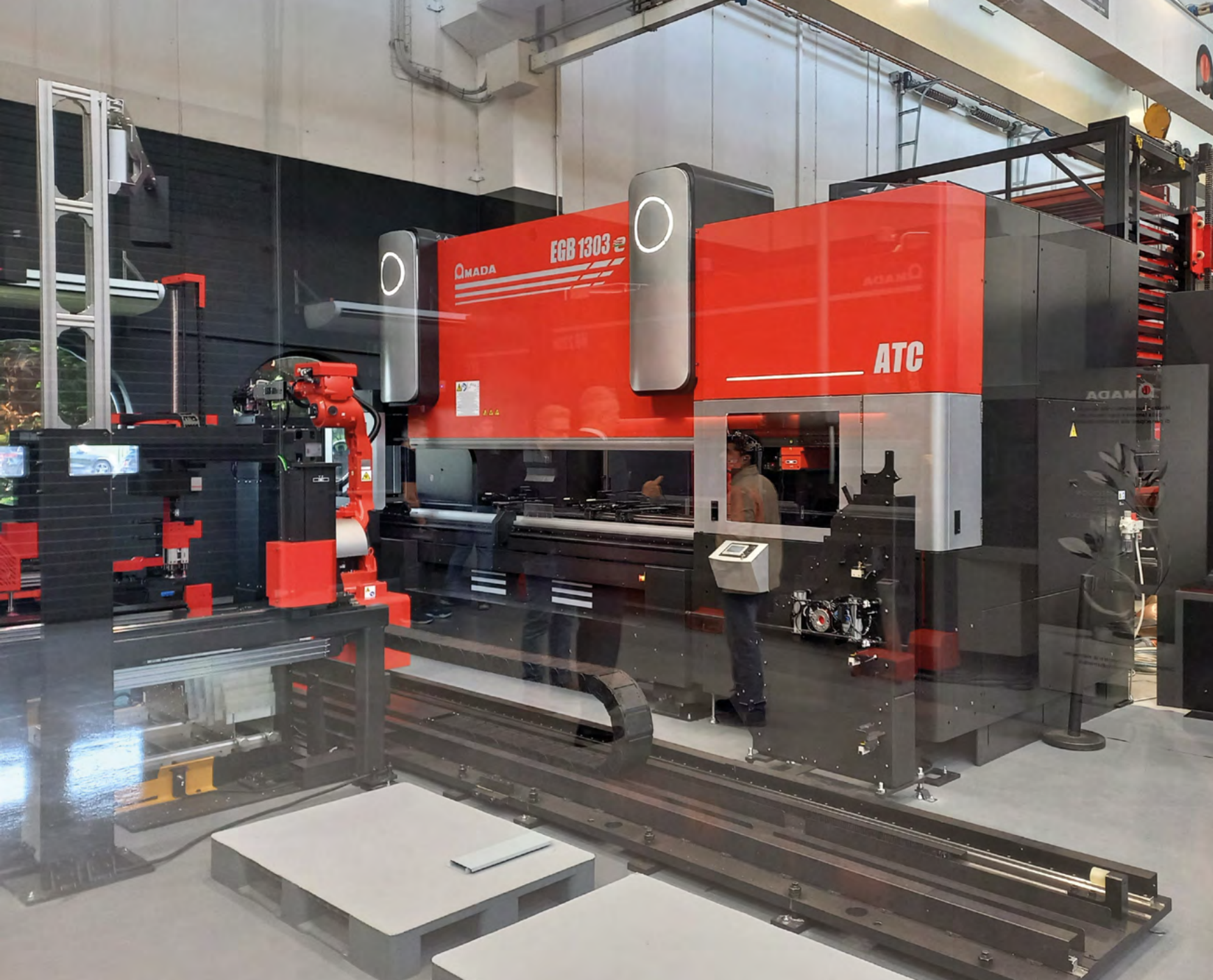
Grazie al Parallel Processing, mentre il robot sta ancora piegando il pezzo precedente, il sistema di carico sta già preparando quello successivo.
