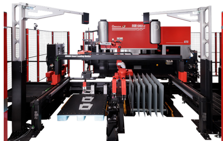
EGB-1303ARse lavora su spessori sino a 6 millimetri e su pezzi della dimensione minima di 90 x 150 millimetri o - grandezza massima - di 1.000 x 800 millimetri
