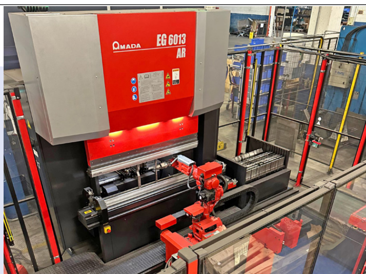
Con la cella EG-6013AR Brembotecnica è riuscita ad automatizzare la piegatura anche di componenti di piccole dimensioni, alleggerendo gli operatori da lavori ripetitivi a scarso valore aggiunto
