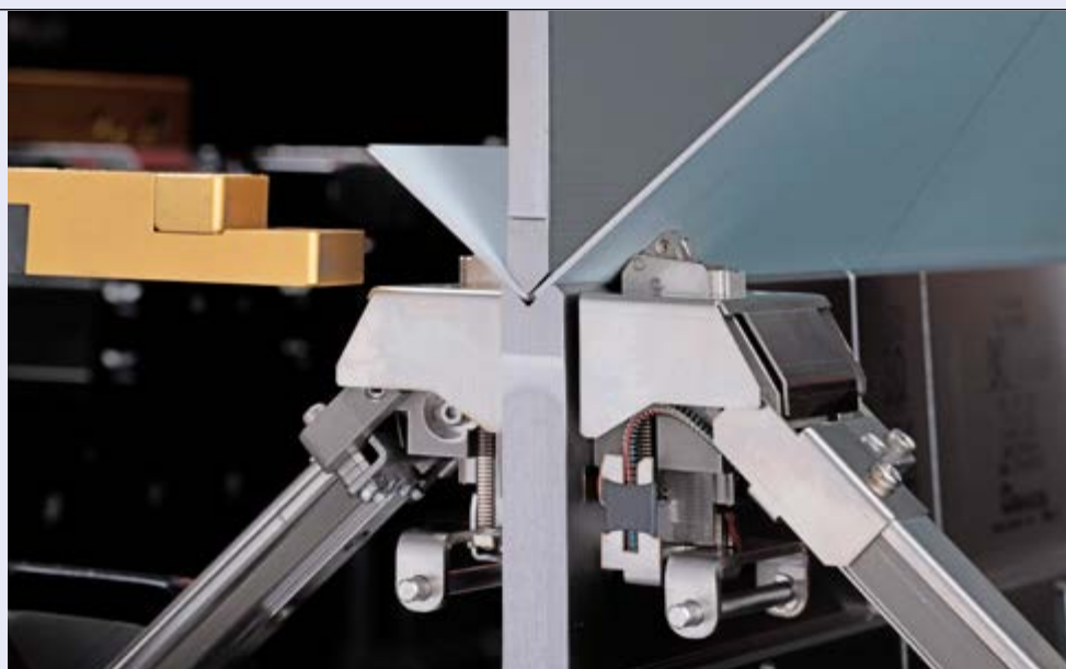
EGB-ATCe è dotata di un nuovo misuratore meccanico di piegatura (Bi-S II) che consente la misurazione dell'angolo fino all'85% più velocemente rispetto ai sistemi precedenti
