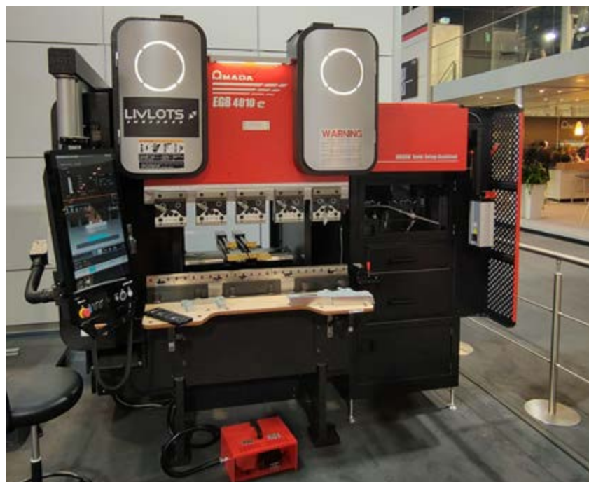
EGB-4010e, che ha fatto il suo debutto europeo a EuroBLECH, è una soluzione totalmente elettrica e compatta, progettata appositamente per produrre componenti piccoli e complessi
