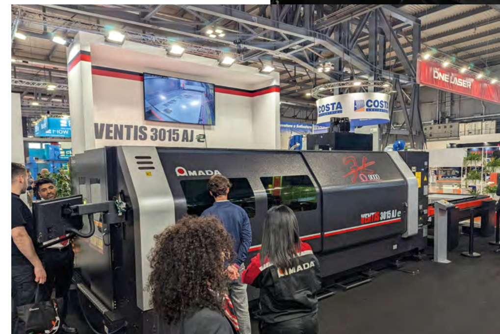
Il sistema di taglio laser VENTIS-AJe da 9kW ha performance paragonabili a laser con potenze superiori.
