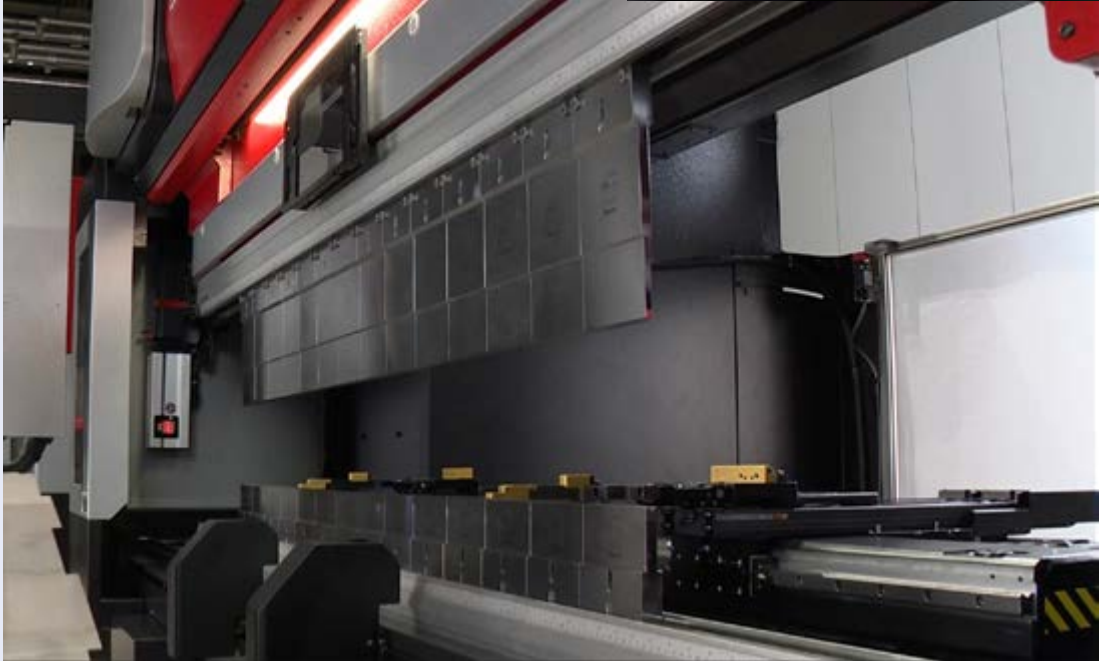
La nuova meccanica posteriore ha tre testine indipendenti, ciascuna con una corsa di 300 mm. Per garantire il perfetto posizionamento delle parti, uno dei due riscontri esterni può essere utilizzato anche come riscontro laterale
