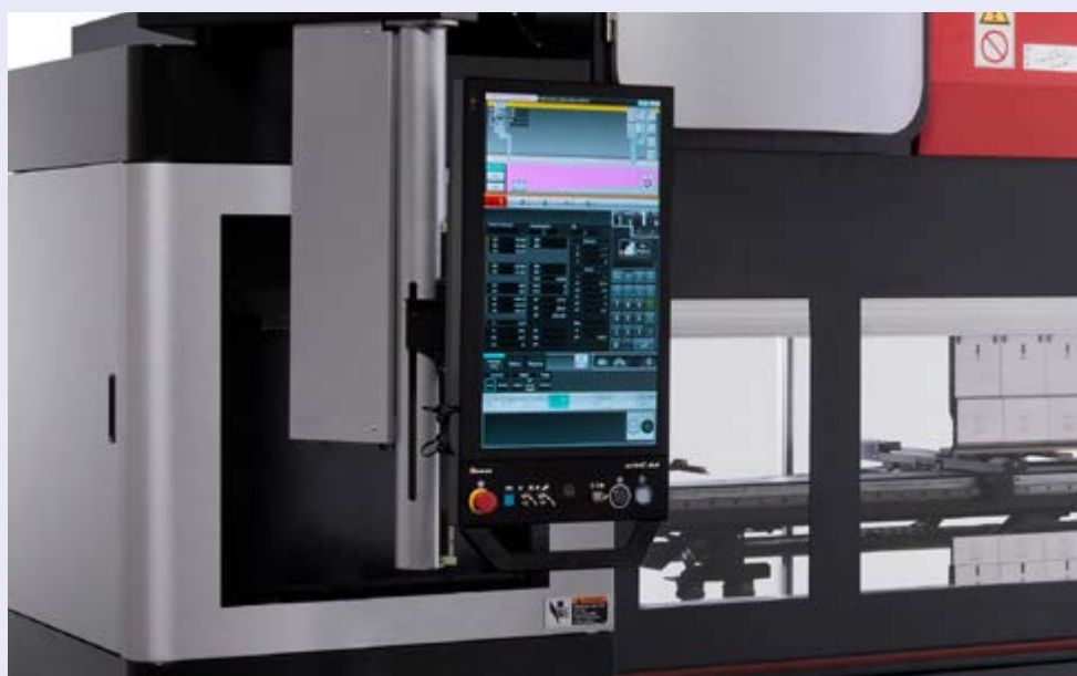
La macchina è dotata del nuovo controllo numerico AMNC 4ie, implementato con nuove funzionalità che semplificano e velocizzano qualsiasi operazione
