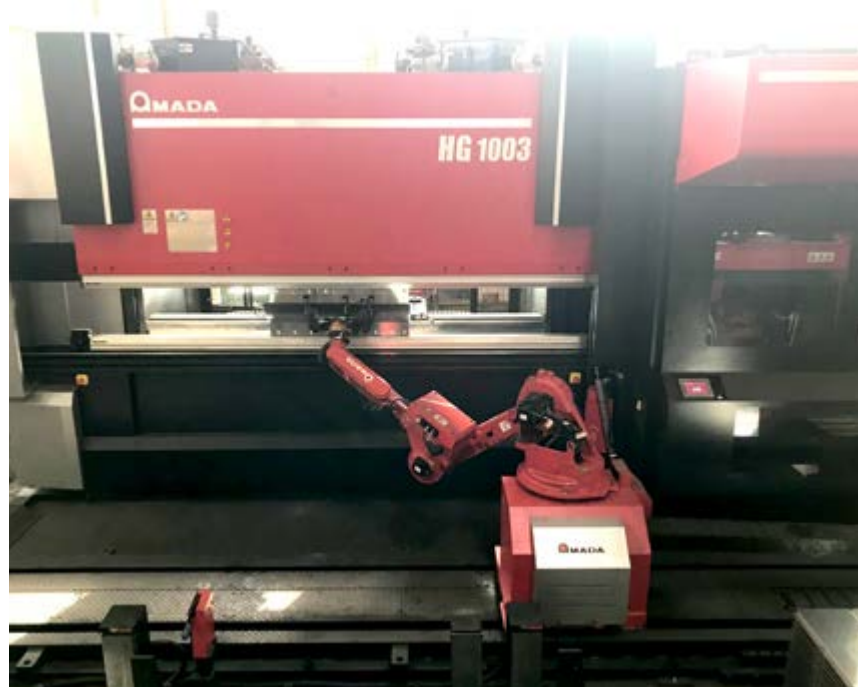
Cella robotizzata HG-ARs di AMADA installata presso Nova Tek. Grazie alla facilità di programmazione e al cambio stampi automatico ATC, in grado di attrezzare il set-up più complesso in meno di due minuti, la cella HG-ARs è una soluzione di piegatura robotizzata perfetta per le carpenterie contoterzi
