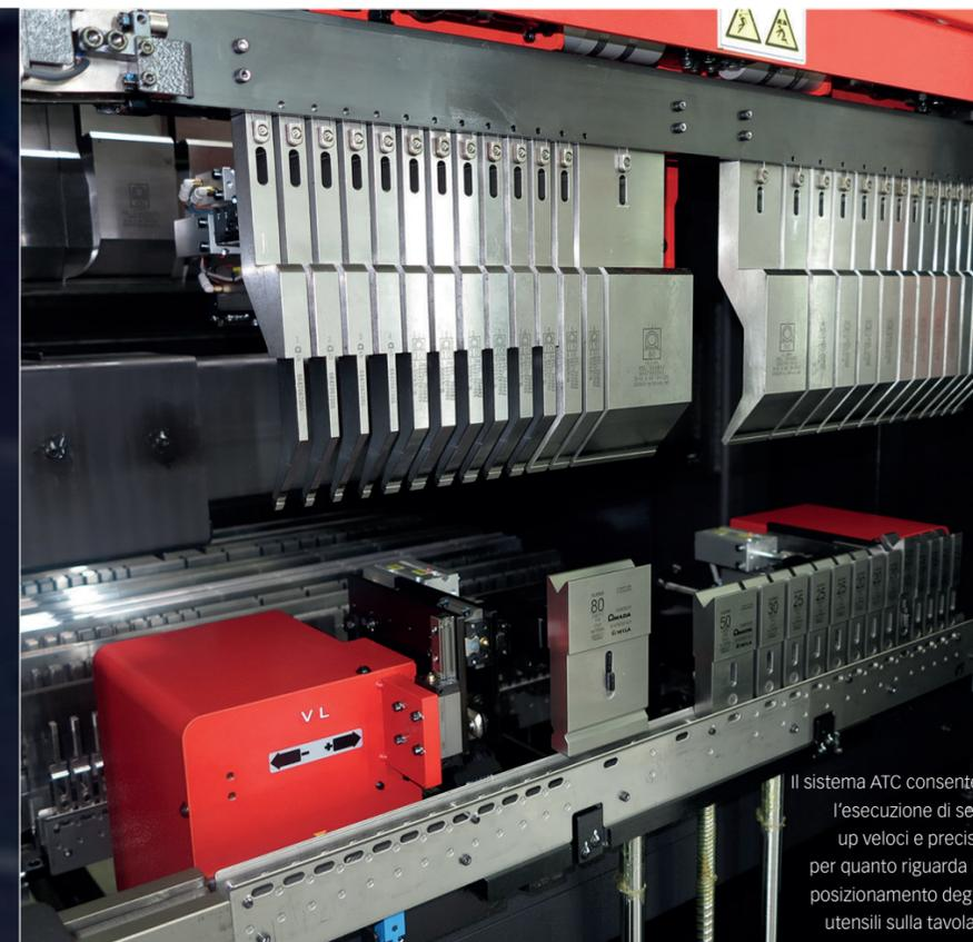
Il sistema ATC consente l'esecuzione di set up veloci e precisi per quanto riguarda il posizionamento degli utensili sulla tavola.
