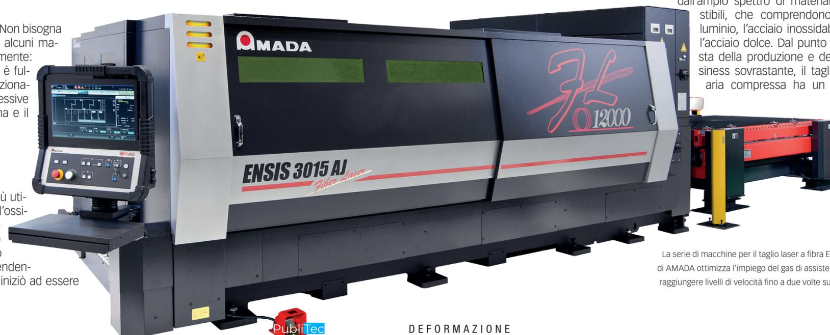
La serie di macchine per il taglio laser a fibra ENSIS AJ di AMADA ottimizza l'impiego del gas di assistenza per raggiungere livelli di velocità fino a due volte superiori.
