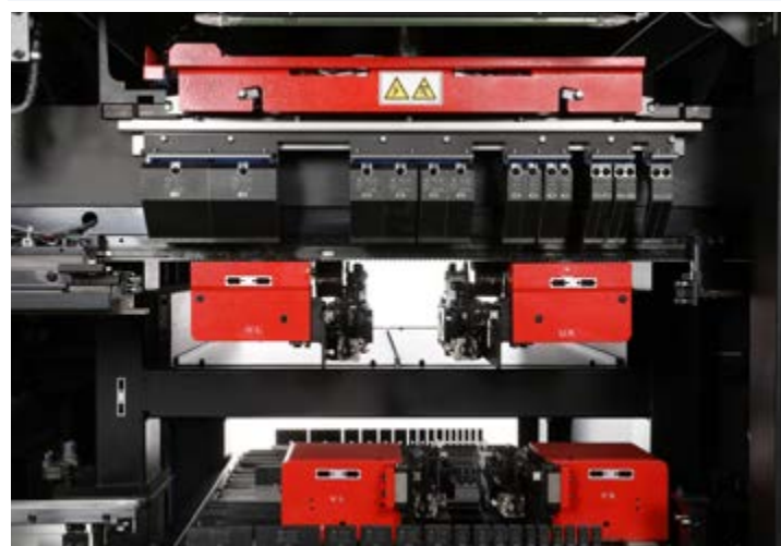
Tratto saliente di HRB-ATC è la presenza del cambio stampi automatico, che in questa nuova versione impiega utensili con attacco Amada. All'interno del magazzino con stocker (15 di punzoni e 18 di matrici, nella configurazione tipica) possono alloggiare in ognuno fino a 800mm di utensili
