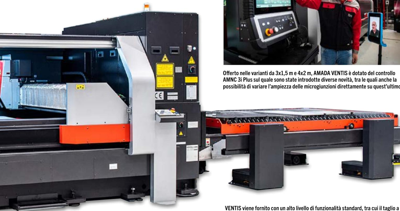
VENTIS viene fornito con un alto livello di funzionalità standard, tra cui il taglio a lente singola, un cambio ugelli automatico a 16 stazioni, un trasportatore degli sfridi sotto l'asse X e un comodo accesso sia frontale che laterale. Inoltre, il sistema di taglio assistito ad acqua (WACS) mantiene costante la temperatura della lamiera
