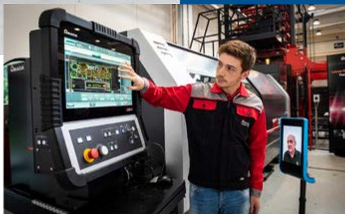
Offerto nelle varianti da 3x1,5 m e 4x2 m, AMADA VENTIS è dotato del controllo AMNC 3i Plus sul quale sono state introdotte diverse novità, tra le quali anche la possibilità di variare l'ampiezza delle microgiunzioni direttamente su quest'ultimo
