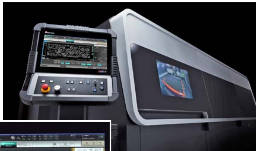
Ad agevolare il funzionamento semplificato del nuovo impianto di taglio laser AMADA REGIUS-AJ sono anche alcune nuove caratteristiche del controllo AMNC 3i Plus, quali il nesting su schermo tramite telecamera e la remotazione del controllo
