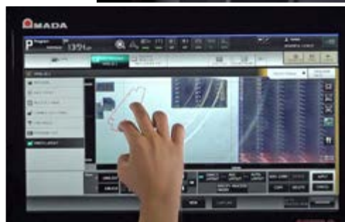
Ad agevolare il funzionamento semplificato del nuovo impianto di taglio laser AMADA REGIUS-AJ sono anche alcune nuove caratteristiche del controllo AMNC 3i Plus, quali il nesting su schermo tramite telecamera e la remotazione del controllo
