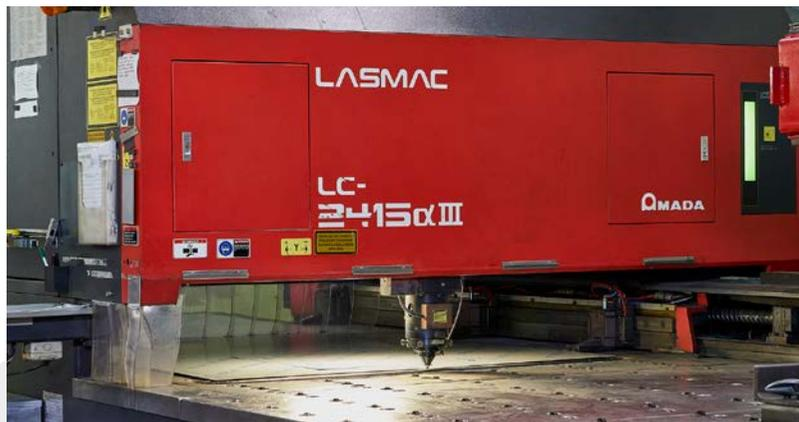
L'impianto a CO<sub>2</sub> Laser LC 2415 Alpha Amada, corredato di automazione LKI 300 MP, consente a Carobbio di tagliare grandi serie delle più diverse tipologie di prodotti, con spessori sino a 10 mm
