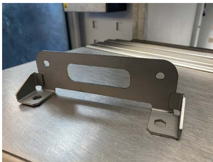
Evoline taglia con ENSIS da quasi due anni materiali come ferro, alluminio e acciaio, oltre a titanio, rame e ottone, in spessori che vanno da un minimo di 1,5 a un massimo di 10 mm
