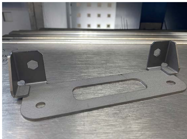
Evoline taglia con ENSIS da quasi due anni materiali come ferro, alluminio e acciaio, oltre a titanio, rame e ottone, in spessori che vanno da un minimo di 1,5 a un massimo di 10 mm
