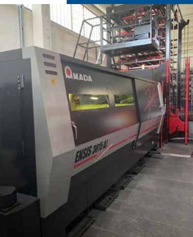
Vista del reparto di taglio in Evoline dove spicca l'impianto di taglio AMADA ENSIS -3015AJ con sorgente da 3 kW, completo di sistema automatico a torre AS-LUL per carico e scarico della materia prima
