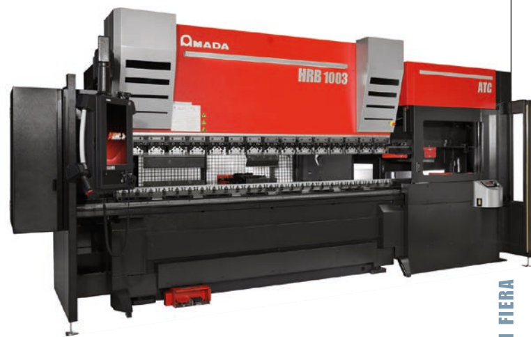
La piegatrice con cambio stampi automatico HRB-ATC
