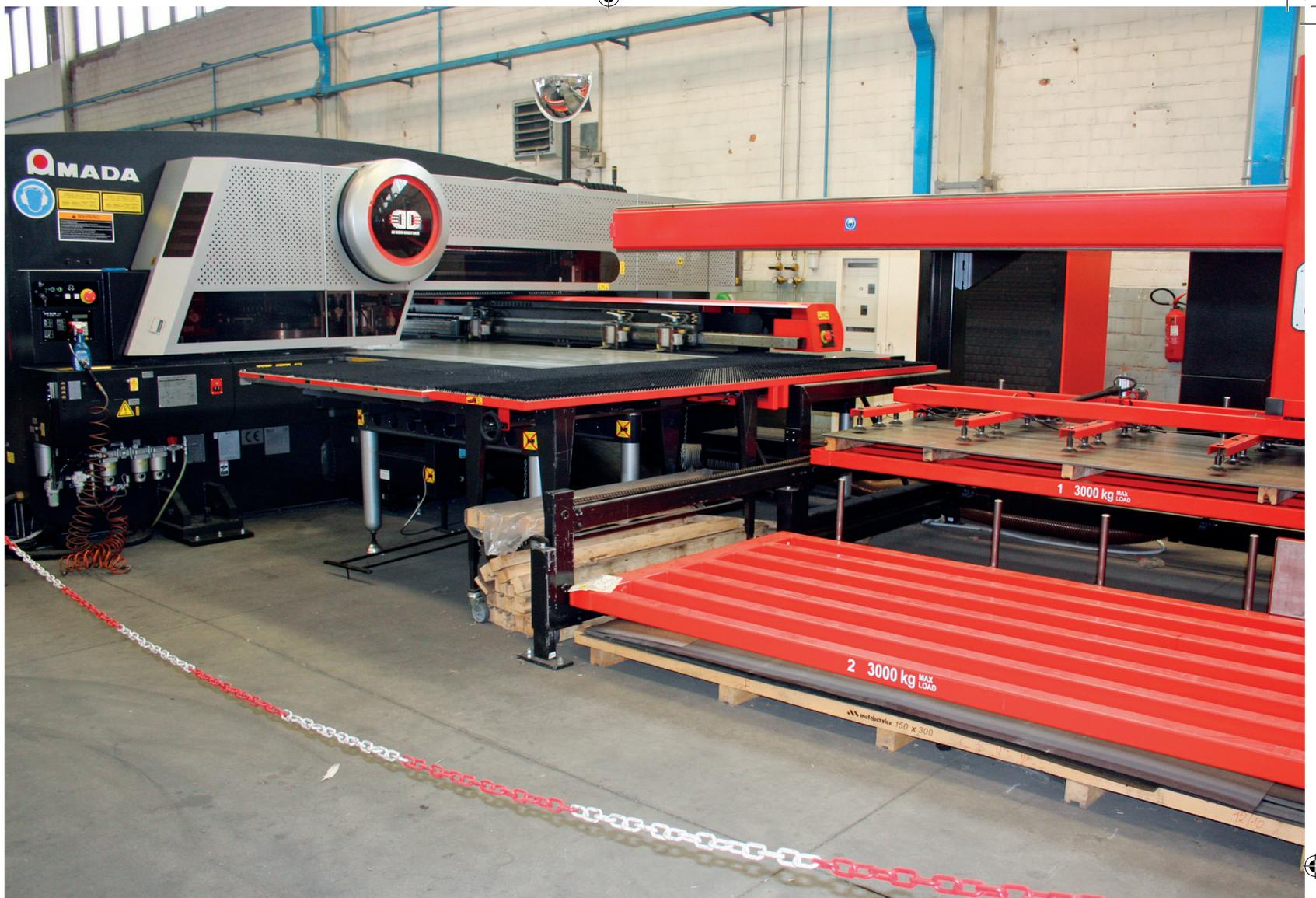
Le combinate EML-3610NT di AMADA sono equipaggiate con un sistema LIII che carica le lamiere in automatico.
