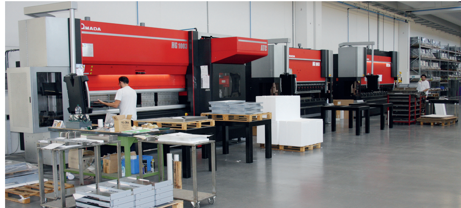
Il reparto di piegatura di Beta è stato rinnovato scegliendo la tecnologia AMADA per sfruttare al massimo i vantaggi dell'integrazione e dell'interconnessione delle macchine. Beta's bending department was revamped with AMADA technology to maximise the benefits of machine integration and interconnection.
