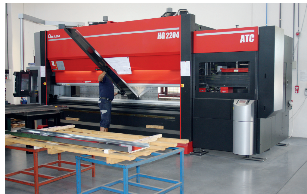
La scelta di dotare la pieghatrice AMADA HG 2204 del sistema ATC garantisce, grazie all'implementazione con l'ufficio tecnico, nuove opportunità con aumenti rilevanti della produttività.
