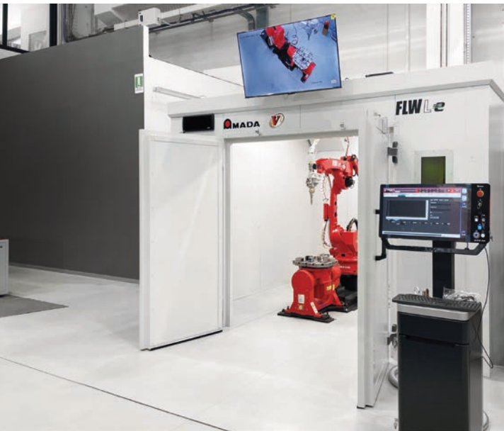
La cabina di sicurezza della FLW-3000 Le è progettata con pannelli concepiti per intercettare e bloccare il raggio laser nel caso fuoriesca dall'area di lavoro
