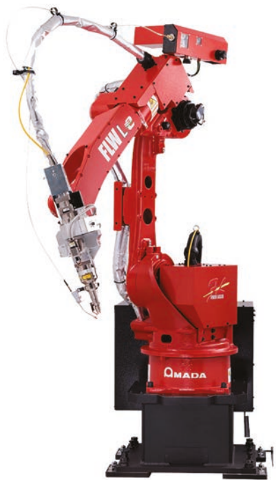
Il robot antropomorfo a 6 assi a elevata velocità e ingombro ridotto
