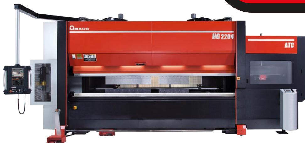
Sopra: la piegatrice HG-ATC, qui nella versione 2204, è la soluzione ideale per la lavorazione di lotti di dimensioni variabili e con layout utensili complesso grazie all'unità di cambio utensili integrata ATC
